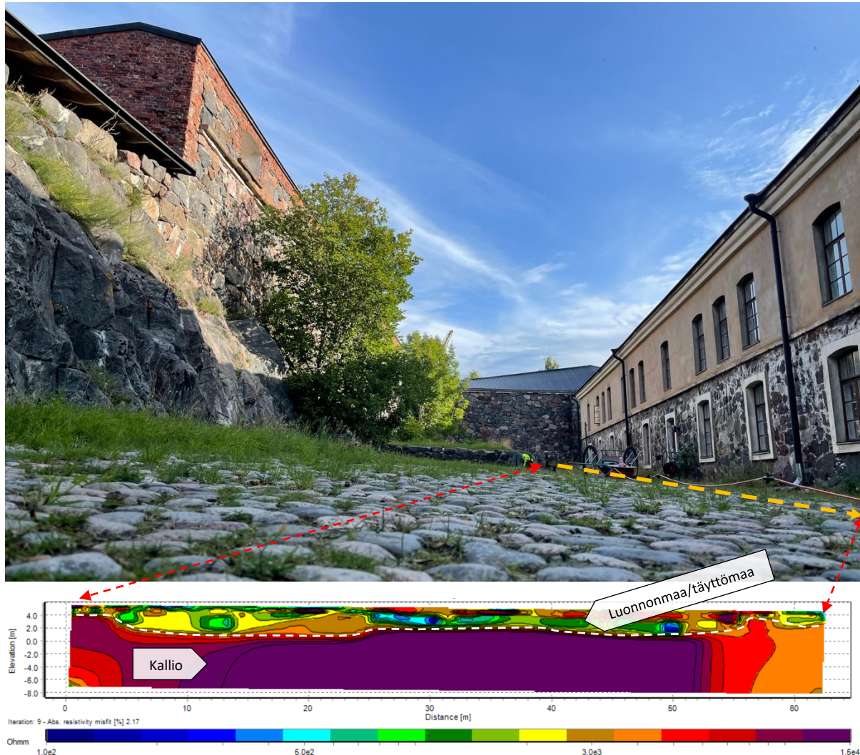
Kuva 8 Kohdealueella suoritetun skannauksen sijainti maastossa on kuvattu valokuvassa suuntaa antavasti oranssilla katkoviivanuolella. (Valokuva on esitetty peilikuvana, jotta sen tulkinta yhdessä tulokuvan kanssa olisi helpompaa. Peilauksella on varmistettu, että molemmat kuvat ovat samoin päin, mikä helpottaa yksityiskohtien vertailua ja kohteiden paikantamista.) Valokuvan alla olevan tulospystyleikkauksen X-akseli kuvaa maan pinnalla (valokuvassa oranssi katkoviiva) kulkevaa mittauslinjaa metreinä (matkapisteet 0–63 m), ja Y-akseli esittää mittauksen syvyyttä metreinä suhteessa merenpinnan tasoon. Arvioitu kalliopinnan ja luonnonmaan/täyttömaan rajapinta on visualisoitu tulokuvassa suuntaa antavasti valkoisella katkoviivalla.
