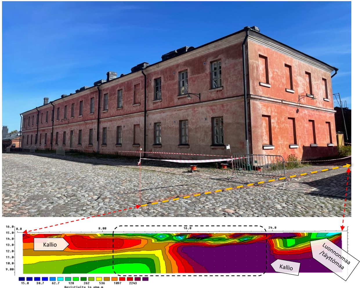
Kuva 10 Kohdealueella suoritettujen skannauksien sijainti maastossa on kuvattu valokuvassa suuntaa antavasti oranssilla katkoviivanuolella. Valokuvan alla olevan tulospystyleikkauksen X-akseli kuvaa maan pinnalla (valokuvassa oranssi katkoviiva) kulkevaa mittauslinjaa metreinä (matkapisteet 0–21 m), ja Y-akseli esittää mittauksen syvyyttä metreinä suhteessa merenpinnan tasoon. Arvioitu kalliopinnan ja luonnonmaan/täyttömaan rajapinta on visualisoitu tulokuvassa suuntaa antavasti valkoisella katkoviivalla. Rakennuksen pääty merkitty tulokuvassa mustalla katkoviivalla.
