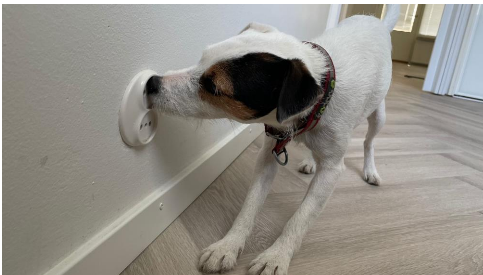
Bild 11. Hunden markerar mikroblukt som sprids via en eldosa. Bild: Leena Stenlund.
