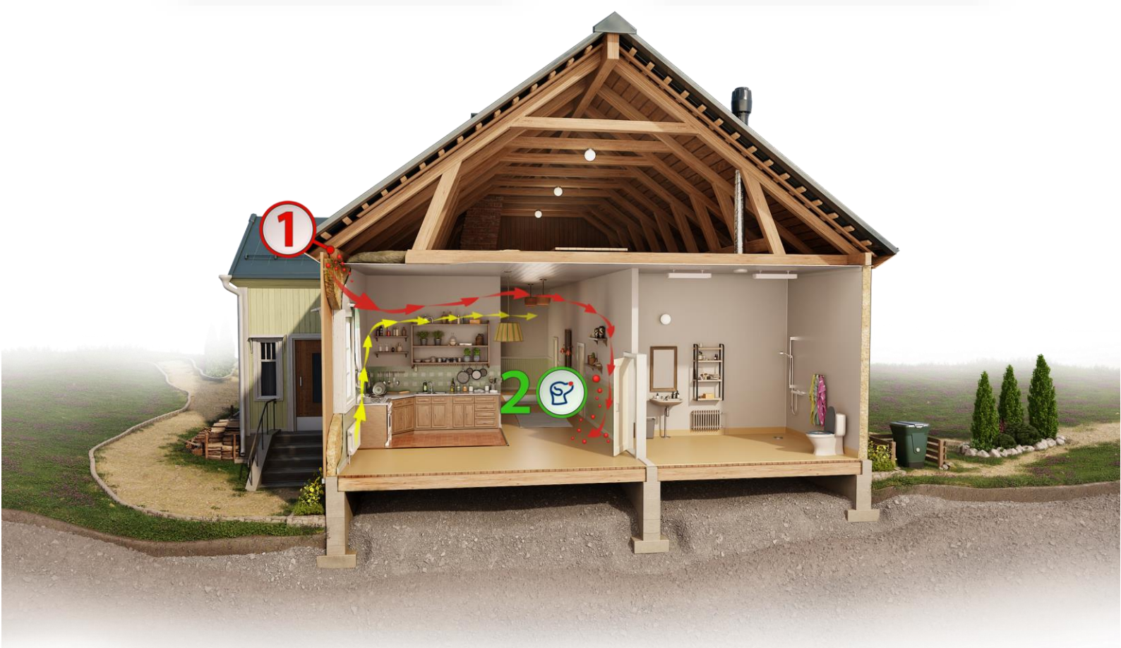
Bild 9. Exempel på hur lukter transporteras med luftströmmen. I ytterväggens övre del finns en fukt- och mikrobskada som beror på läckor i yttertaket (punkt 1). Fogen mellan ytterväggen och vindsbjälkslaget är inte luft- eller gastät in mot byggnadens inomhusutrymmen. Skadan orsakar mikroblukter inomhus. Värmebatteriet på ytterväggen skapar ett uppåtriktat varmt luftflöde som sjunker ner längs den andra väggen. Hunden upptäcker mikroblukten från skadan i ytterväggens övre del på den motsatta väggens övre del (punkt 2).
