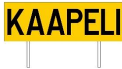
Kuva 36. Kaapeli- ja johtotaulu
