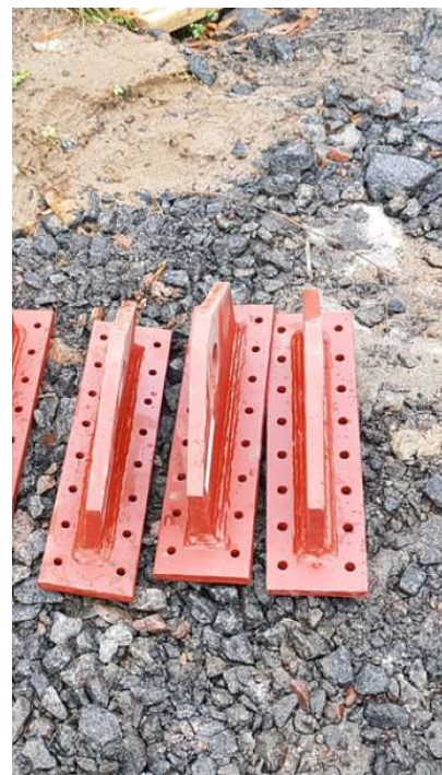
Kuva 18. Vaihtoehtoiset nosto-osat tilaelementin päältä nostamiseen
