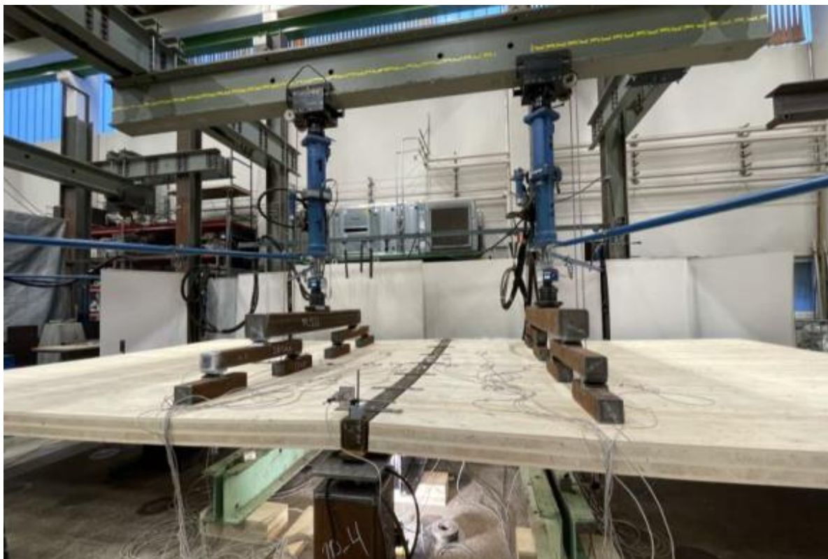
Kuva: DI Aku Aspilan väitöskirjatutkimukseen liittyviä CLT-kokeita TAU:n Rakentamistekniikan yksikön testihallissa.
