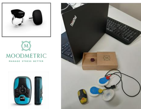
Kuva 2. Tutkimuksessa mitattiin sykevariaatiota Bittium FAROS EKG-laitteella ja ihonsähköjohtavuutta Moodmetric-älysojmuksella (Vigofere Oy).
