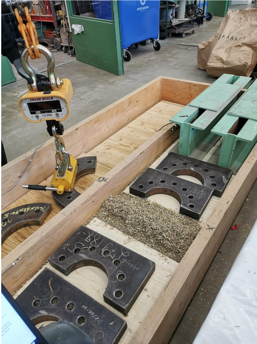
Kuva 8. Rakenteen E5 savetetun kutterilastueristeen tiivistäminen puristamalla.
