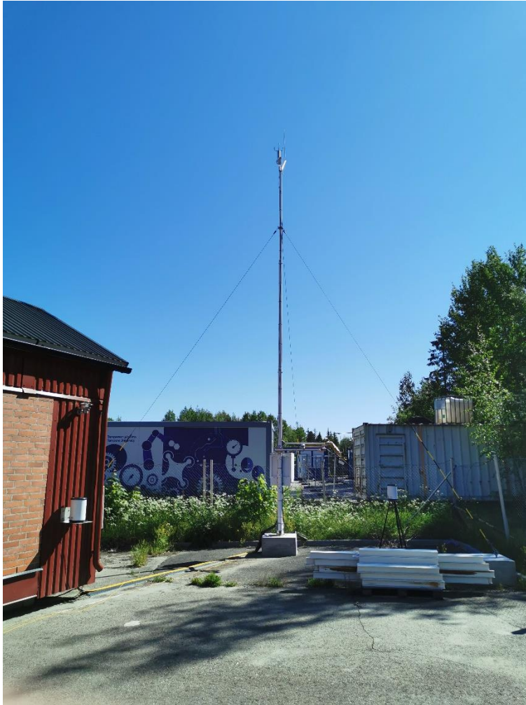
Kuva 18. Koerakennusalueen sääasema Vaisala AWS310.
