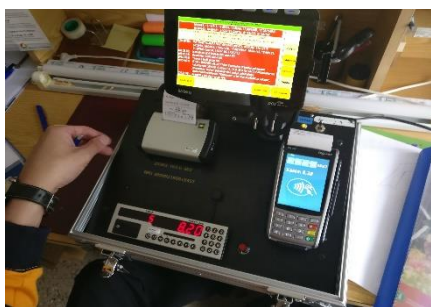
Kuva 3: Tyypillisen taksiauton varusteet: taksamittari, kuittitulostin, tilausvälityspäätte ja maksupäätte. 23
