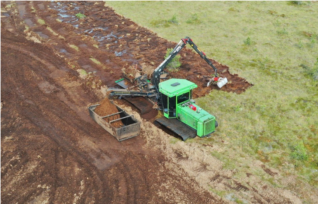
Kuva 1. Rahkasammalen korjuukone Tuurannevalilla. Kuva: Ari Koski.
