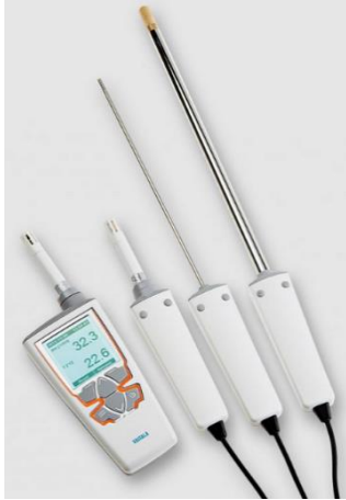
Kuva M.2.6. Suhteellisen kosteuden lukulaite ja mittapäitä
