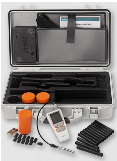
Kuva M.2.7. Rakennemittauksiin (RH-%) soveltuva laitteisto Vaisala SHM40
