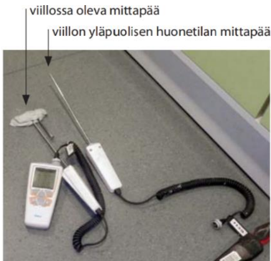
Kuva 22. Viiltomittaus käynnissä muovimatolla (Rakennustietosäätiö RTS 2021).
