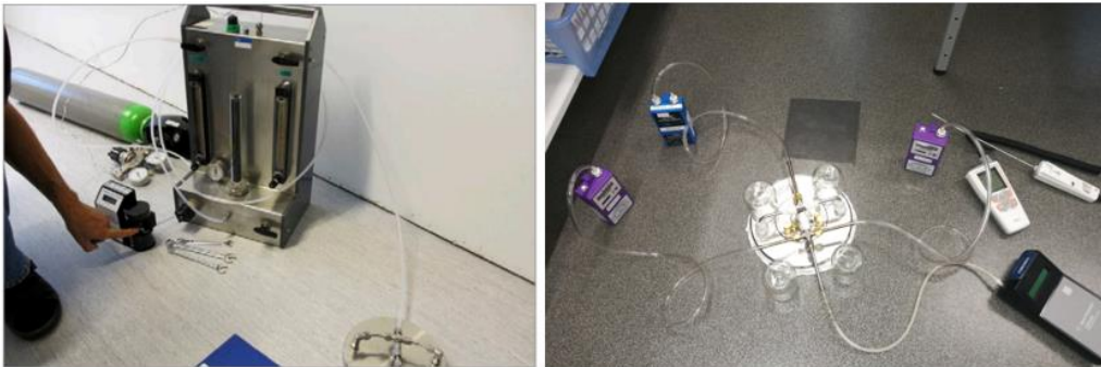
Kuva 26. Lattiapinnan emissiomittaus FLEC-menetelmällä. Vasemmassa kuvassa standardin ISO 16000-10 mukainen menetelmä (Kuva: Ympäristöopas 2016) ja oikeassa kuvassa ohjeen NT Build 484 mukainen menetelmä (Kuva: Vahanan Rakennusfysiikka Oy).
