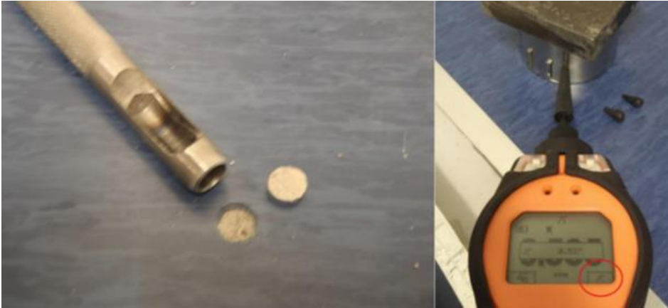
Kuva 28. Vasemmalla PID-näytteenottokohdan avaaminen ja oikealla mittaus käynnissä (Kuva: Leivo et al. 2021).
