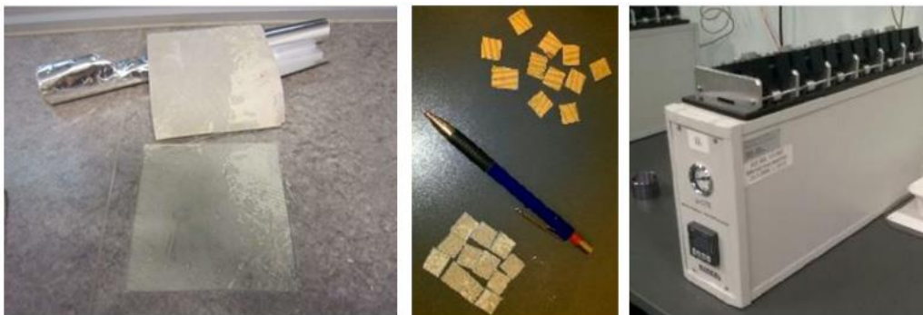
Kuva 27. Bulk-mittauksessa materiaali suljetaan näytteenoton jälkeen tiiviisti alumiinifolioon ja uudelleen suljettavaan pussiin ja toimitetaan analyysilaboratorioon. Keskellä kuva pilkotusta materiaalista ennen mikrokammioon sulkemista ja oikealla kuva mikrokammioilaitteistosta (kuvat: Vahanen Rakennusfysiikka Oy).
