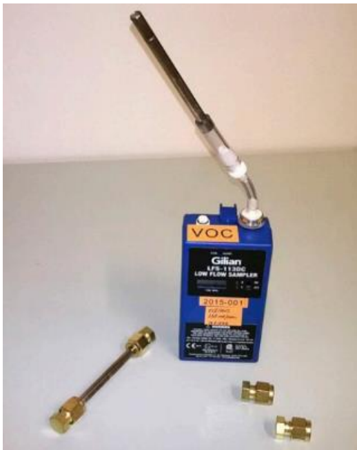
Kuva 25. Sisäilman VOC-näytteen keräys pumppuun kytketyllä adsorbenttikeräimellä (Ympäristöopas 2016).
