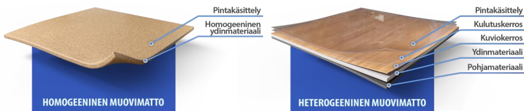
Kuva 3. Heterogeenisen ja homogeenisen muovimaton tyypillinen rakenne.
