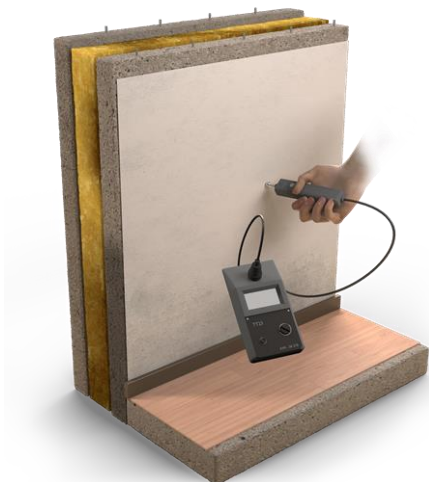
Kuva 7. Pintakosteudenilmais (vain suuntaa antava tietoa kosteuspitoisuuden vaihtelusta samanlaisen rakenteen eri osissa).
