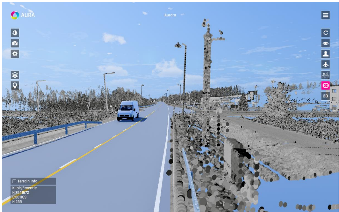
Kuva 4.7: esimerkki tiheään pistepilviaineiston (väyläympäristö) ja vektoriaineiston (maantie ja tie-merkinnät) yhdistämisestä samaan Sitowisen AURA-käyttöliittymäympäristöön. Lähde: Sitowise, Liikennevirasto 2018.
