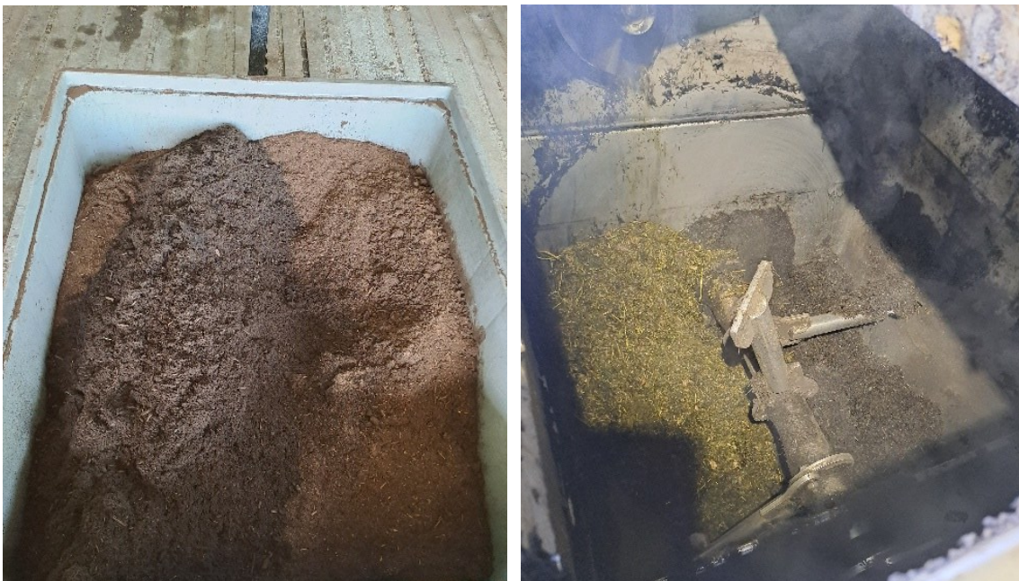
Kuva 5. Oikealla tuoretta ja vanhempaa tuotosta kompostorissa, vasemmalla valmista tuotetta poistettuna kompostorista.
