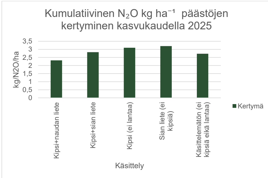
Kuva 20. Dityppioksidin teoreettinen kumulatiivinen kertyminen kasvukaudella 2025 koejäsenittäin. Päästöt on ilmoitettu kilogrammoina hehtaaria kohden.
