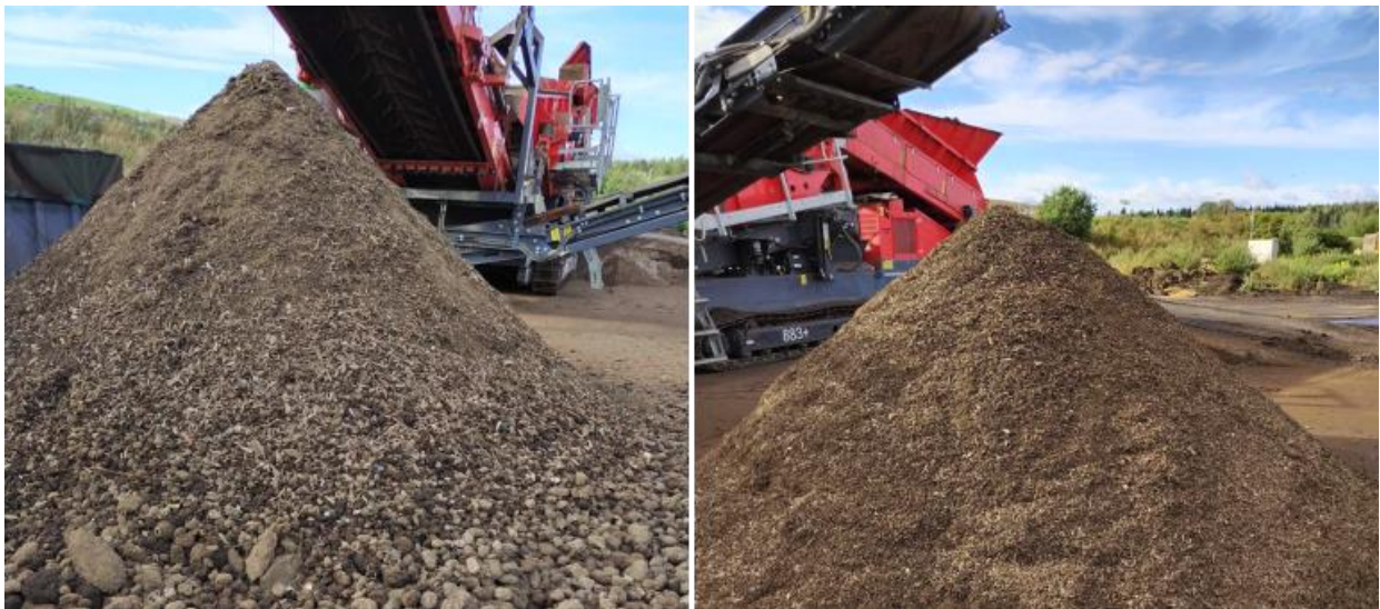
Kuva 16. Kompostin seulonnan ylitte (> 15 mm:n jae) (vas. kuva) ja välijae (8–15 mm) (oik. kuva). Kuvat Niko Kytölä.
