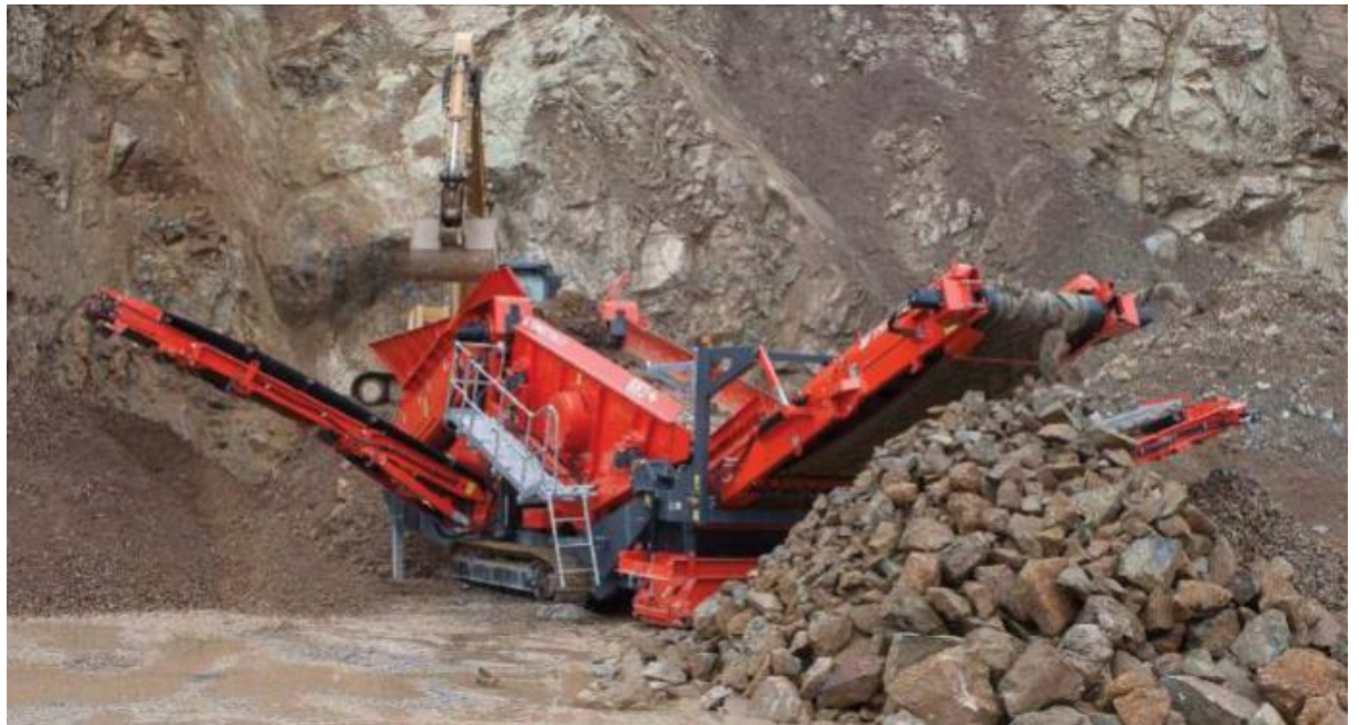
Kuva 5. Pilotissa käytetty mobiiliseula TEREX FINLAY 883+. Kuva Terex.com.
