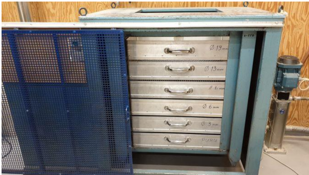
Kuva 4. Laboratoriossa tehdyssä seulontakokeessa käytetty hakeseula. Kuva Camilla Inkeroinen.
