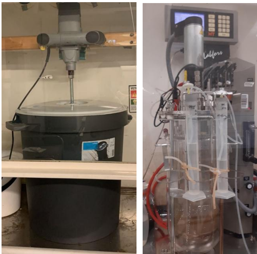
Kuva 5. Pienen pilottimittakaavan hydrolyysi (vasen) ja PHA:ta keräävien bakteerien rikastus ja akkumulaatiobioreaktori (oikea).
