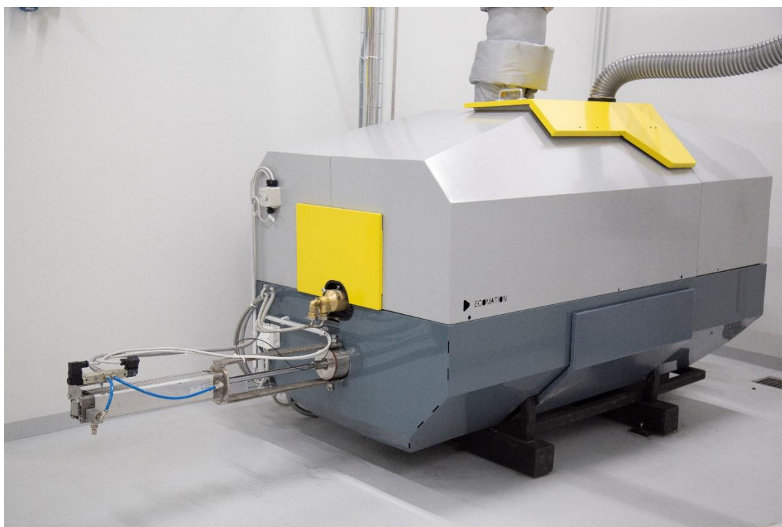
Kuva 9. Panostoiminen pyrolyysilaitte LAB-ammattikorkeakoulun kiertotalouslaboratoriossa.
