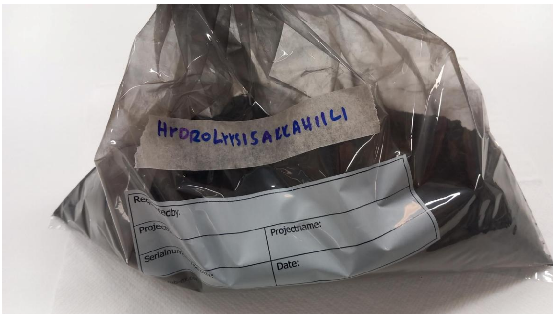
Kuva 13. Pyrolyysihiili hydrolyysisakasta. Tässä näytteessä oli enemmän jauhemaista pölyävää hiiltä.
