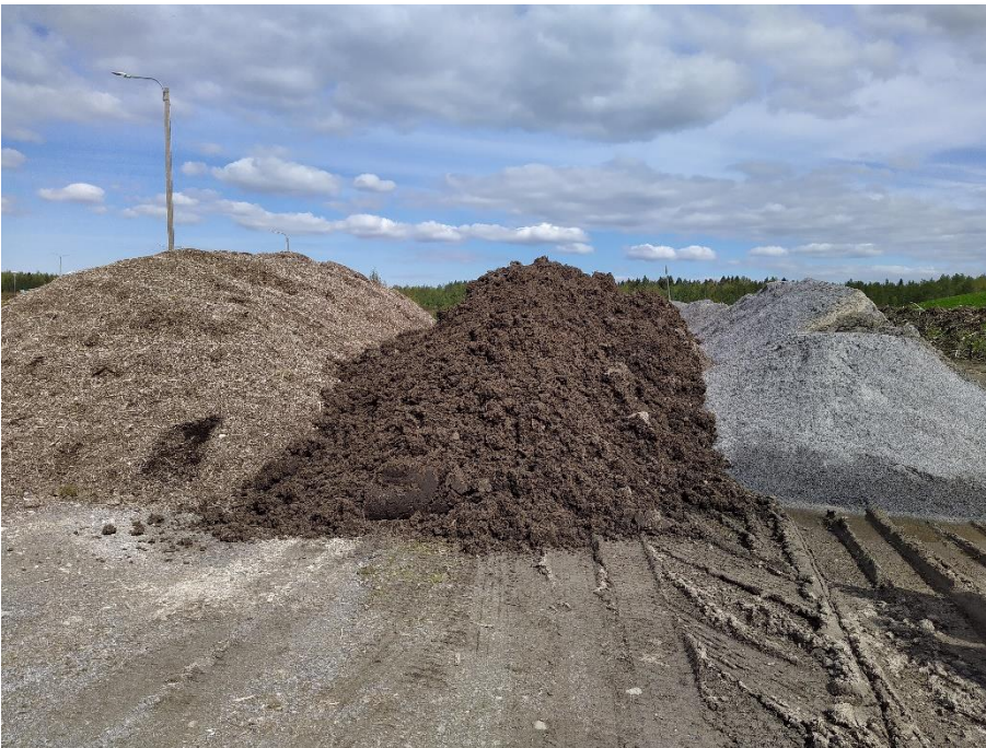
Kuva 3 Kiertotalouspohjaisen mullan raaka-aineet - murskattu risualite, maanparannuskomposti ja kivituhka. 2021
