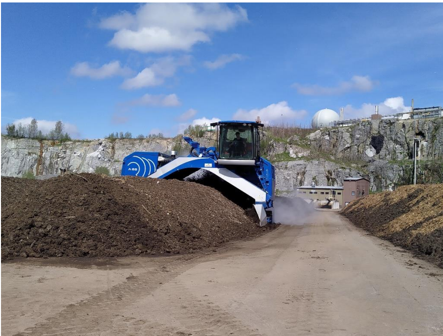
Kuva 1 Murskattu risu on sekoitettu mädätettyyn lietteeseen. Aumaa käännetään, mikä edesauttaa kompostoitumista.2021
