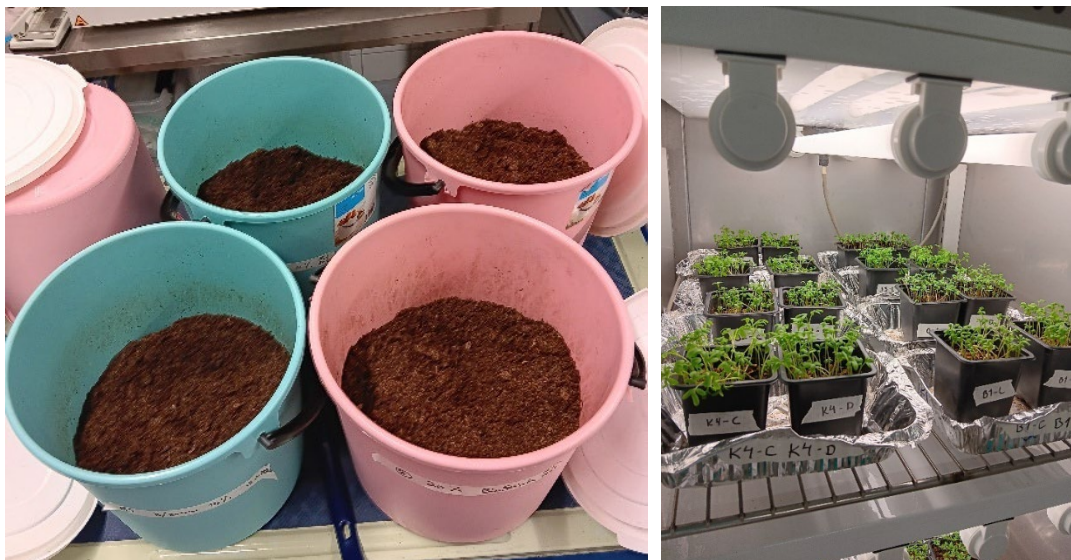
Kuva 3. Jätevesilietepohjaisista mädätteistä valmistettiin kasvualustaseoksia ja niille tehtiin kasvatuskokeita kontrolloiduissa olosuhteissa. (Kuvat Jonna Hauvala)
