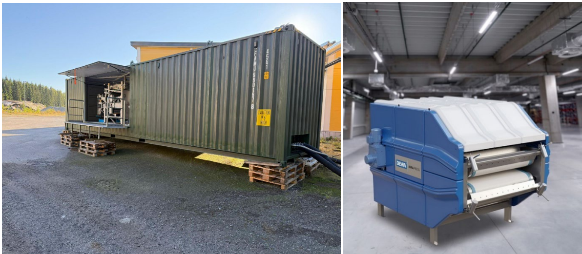
Kuva 2. Dewacon koeajokontti ja Aura-suotonauhapuristin. (Kuvat Rikku Kettunen)
