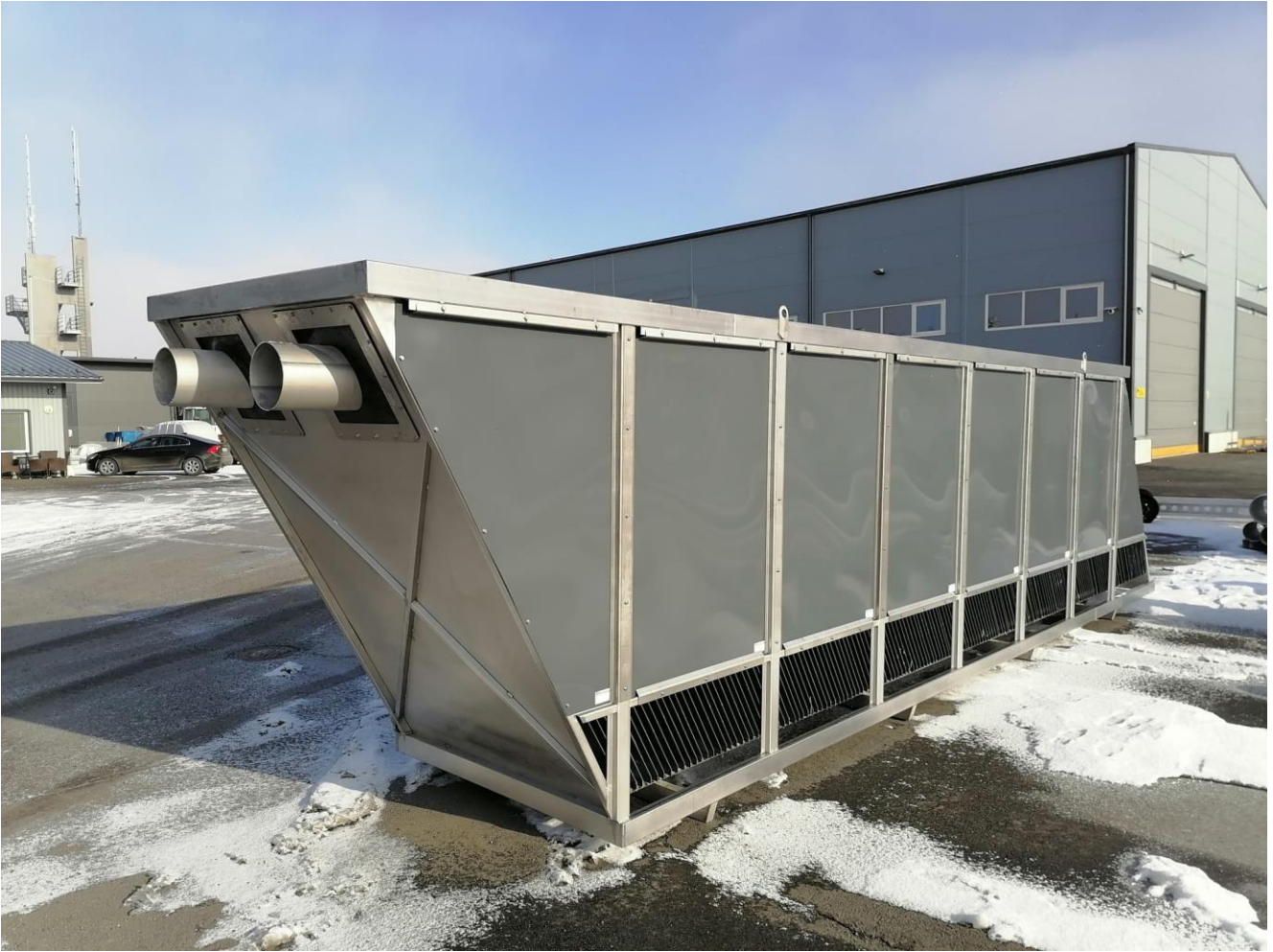
Kuva 2 Lamelliselkeytin odottaa jo asennusta betonialtaaseen huhtikuussa.
