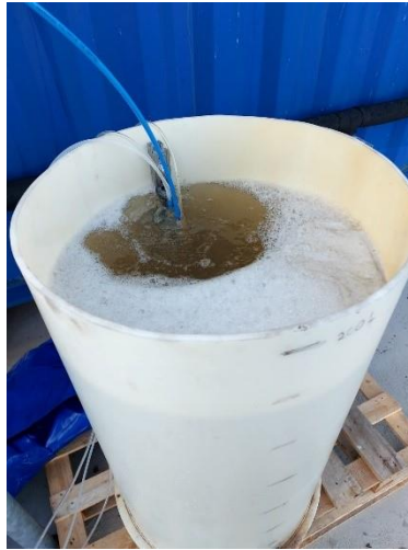
Kuva 3. MBR-yksikkö ilmastaa näytettä
