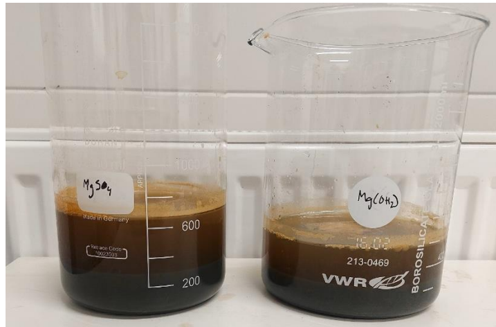
Kuva 10. Struviitin saostus MgSO_4 (vas.) ja Mg(OH)_2 (oik.) ainemääräsuhteilla 7:14:1 ( Mg^{2+}:NH_4^+:PO_4^{3-} )
