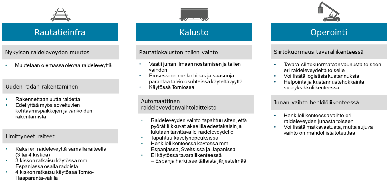
Kuva 4. Ratkaisut raidelevyteen siirtymiseksi eri tasoilla.
