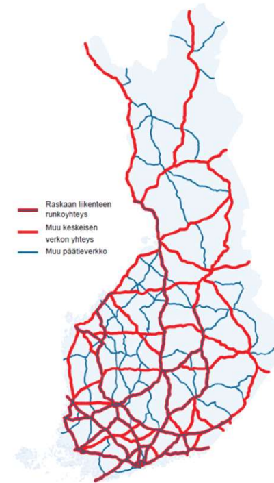
Kuva 4.1. Päätieverkon luokittelu keskeisiin päteihin, raskaan liikenteen runkoyhteyksiin ja muihin päteihin.
