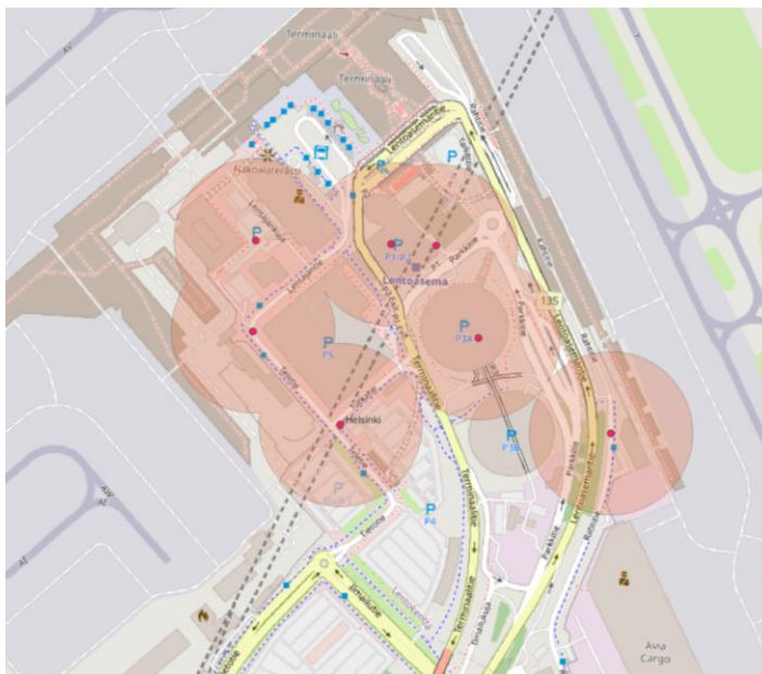
Kuva 8. Esimerkki seitsemän latausaseman muodostamasta poolista Helsinki-Vantaan lentoasemalta.
