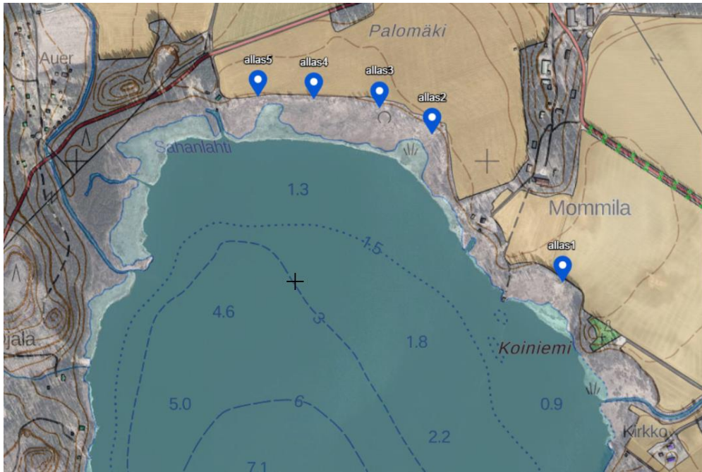
Kuva 11. Salaojien purkupisteisiin rakennettiin yhteensä viisi laskeutusallasta. Allas 1 oli altaista suurin, noin 450 m. 2
