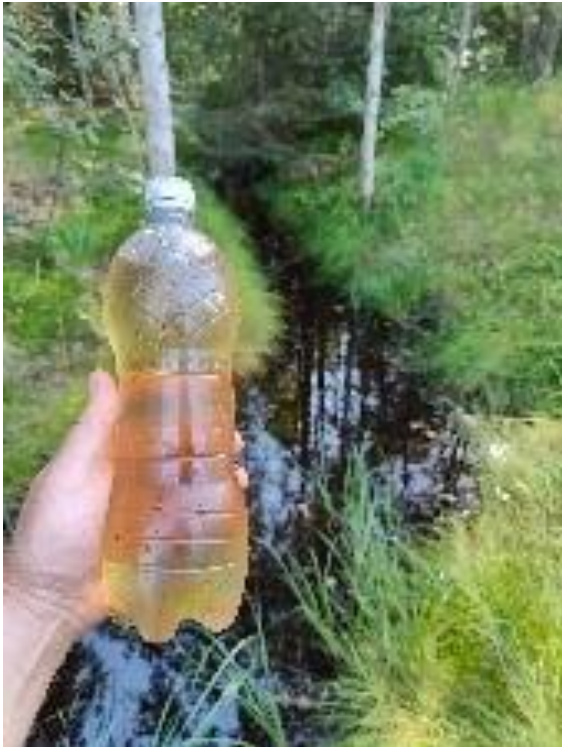
Kuva 41. Vesi näytti ”riittävä” likaiselta, mutta analyysi osoitti vedenlaadun olevan riittämätön reaktoreille asetettuihin puhdistustavoitteisiin (Kuva Juha-Pekka Saarelainen)
