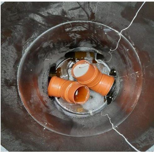
Loggerit kaivossa mittaamassa sähkönjohtavuutta
