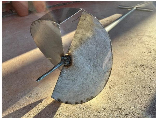
ö. Työvälineet tarpeiden mukaan: kaivon reaktoriin mitoitettu hakekaira
