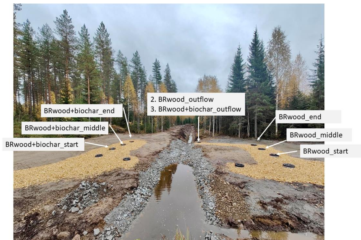
Kuva 20. Bioreaktoreiden ja niistä lähtevän veden mittauspisteet. BRwood= puuhakebioreaktori, ja BRwood+biochar = biohiili+puuhakebioreaktori (Kuva Kirsi Karhio, merkinnät Heini Postila)
