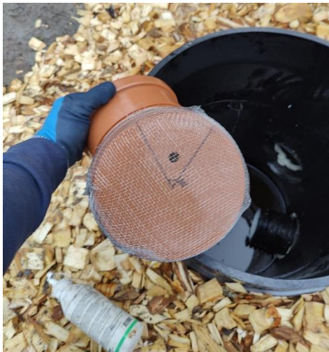
ä. Reikäkantta muuttamalla säädetään tulevaa virtaamaa
