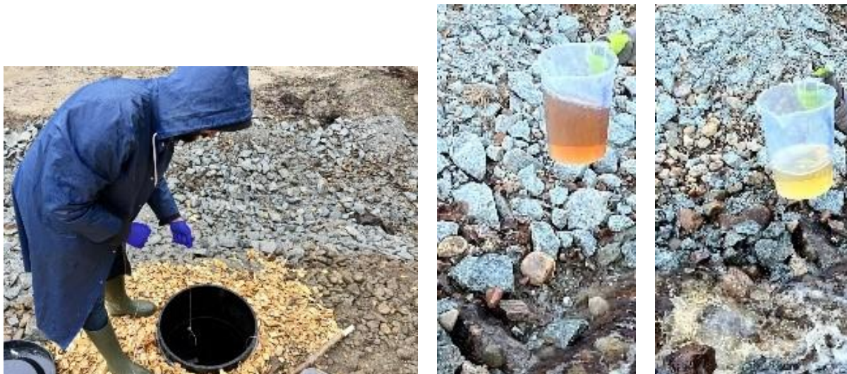
Kuvat 36 a, b, c. Matthew Hopkins asentaa mittakaivon HOB0-sähkönjohtavuusloggeria vedenlaatua mittaamaan, 29.2.2022 (vasen kuva). Veden väri ennen bioreaktorirakennetta (keskimmäinen kuva) ja bioreaktorirakenteen jälkeen (oikea kuva), 30.10.2022. (Kuvat Kirsi Karhio)
