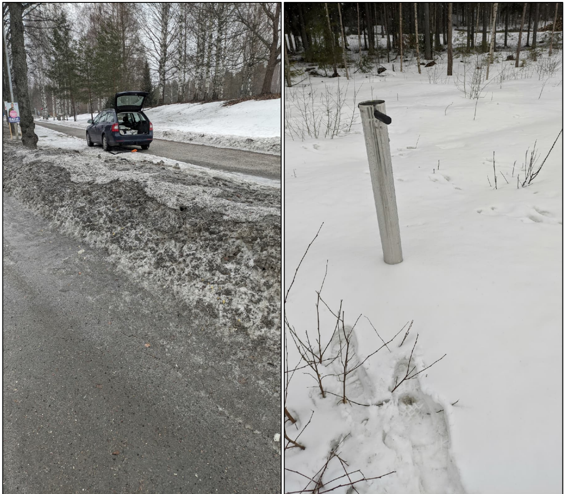
Kuva 2. Hirsimetsäntien aurattua tienvarsilunta (vas.) ja koskematon lumialue Ala-Okerointientien läheisyydessä sekä lumipuntari (oik.). (Kuvat Onni Varjos/Sitowise)
