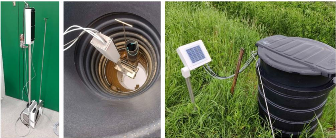
Kuva 7. ESKE- hankkeen etähallittava säätösalaojakaivo. Lähde: Toni Liedes / Oulun yliopisto.
