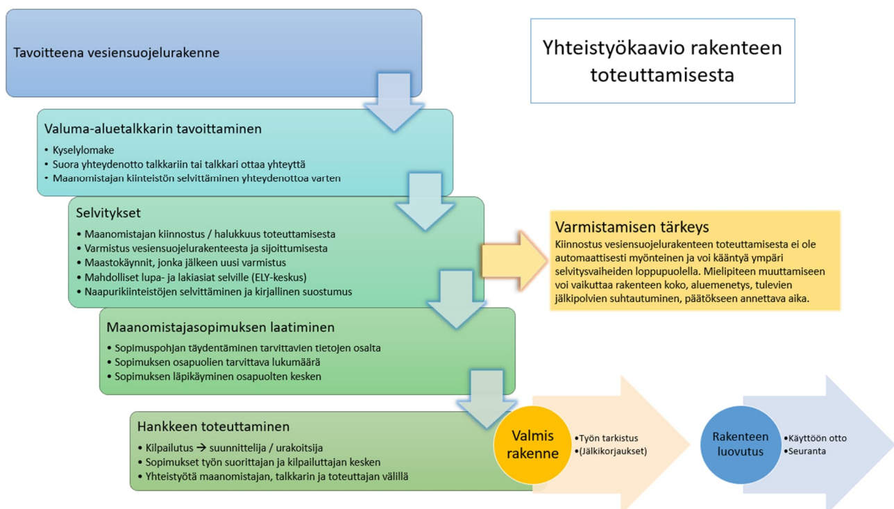
Kuva 4. Yhteistyökaavio rakenteen toteuttamisesta.
