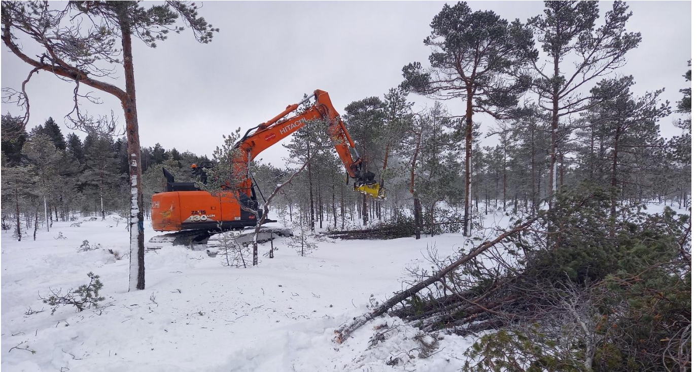
Kuva 3. Suon keskiosissa puunkorjuu perustui telakaivinkoneeseen yhdistetyllä giljotiinikouralla toteutettavaan metsäenergian korjuuseen.
