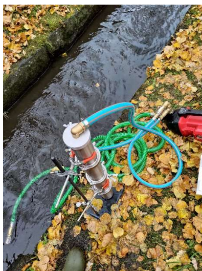
Kuva 8. Mikromuovien näytteenottomenetelmä. Punaisella akkukäyttöisellä pumpulla pumpataan vesi kohteesta letkun kautta teräsputkeen, johon voi laittaa 1–3 suodatinta keräämään eri kokoista kiintoainesta.
