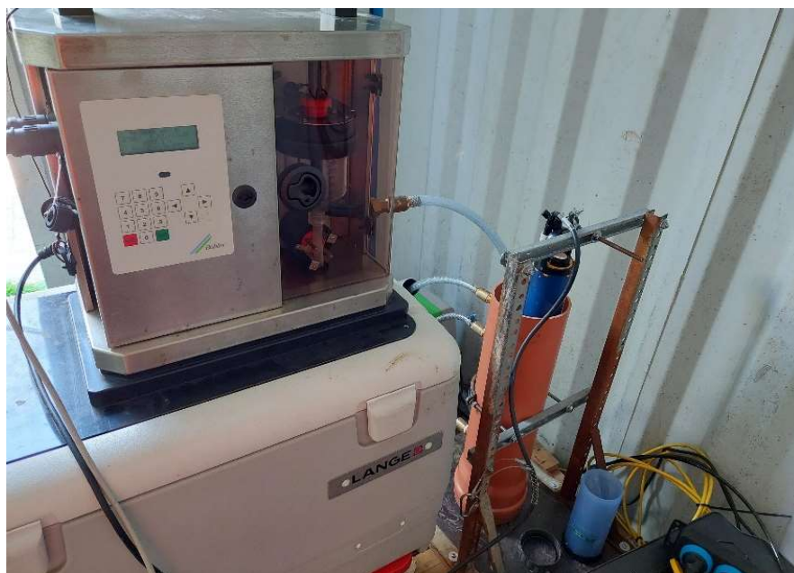
Kuva 7. Automaattinen näytteenotin (vasemmalla) ja säilytyskaappi (alla) sekä jatkuvatoiminen vedenlaatumittari (oikealla).
