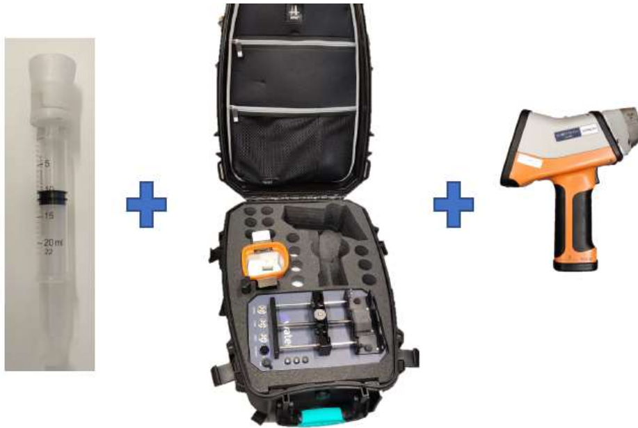
Kuva 11. Liukoisen metallin kenttämittauslaitteisto (kuva 3AWater).
