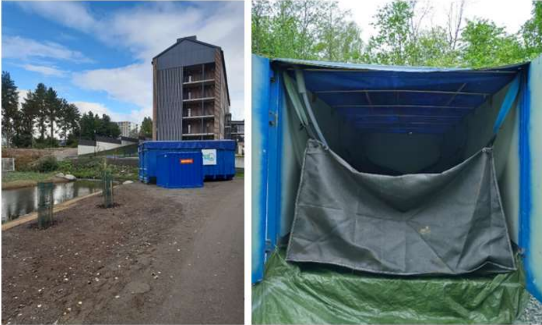
Kuva 14. Biopolymeerisaostusmenetelmän koejärjestelyt. Vasemmalla etualalla olevassa kontissa on virtaaman mittaus ja kemikaalin annostelu. Vasemmalla takana sekä oikeanpuoleisessa kuvassa suodatinyksikkö.
