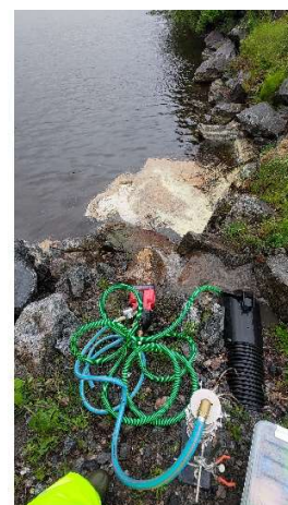
Kuva 8. Mikromuovien näytteenottomenetelmä. Punaisella akkukäyttöisellä pumpulla pumpataan vesi kohteesta letkun kautta teräsputkeen, johon voi laittaa 1–3 suodatinta keräämään eri kokoista kiintoainesta.
