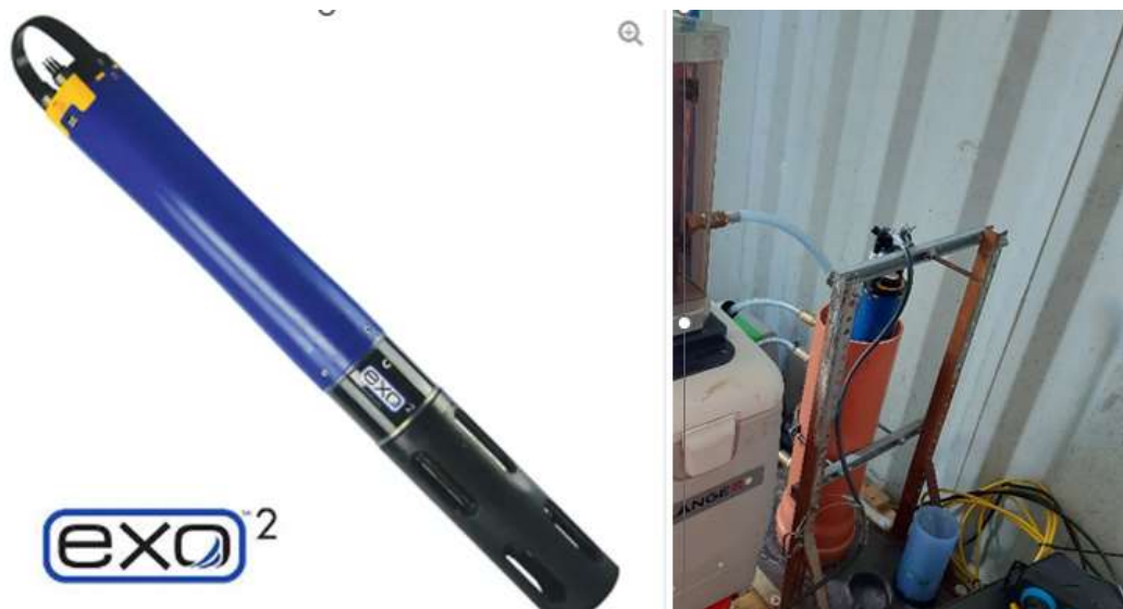
Kuva 10. Hankkeessa käytetty jatkuvatoiminen vedenlaatuanalysointilaite (YSI EXO2).
