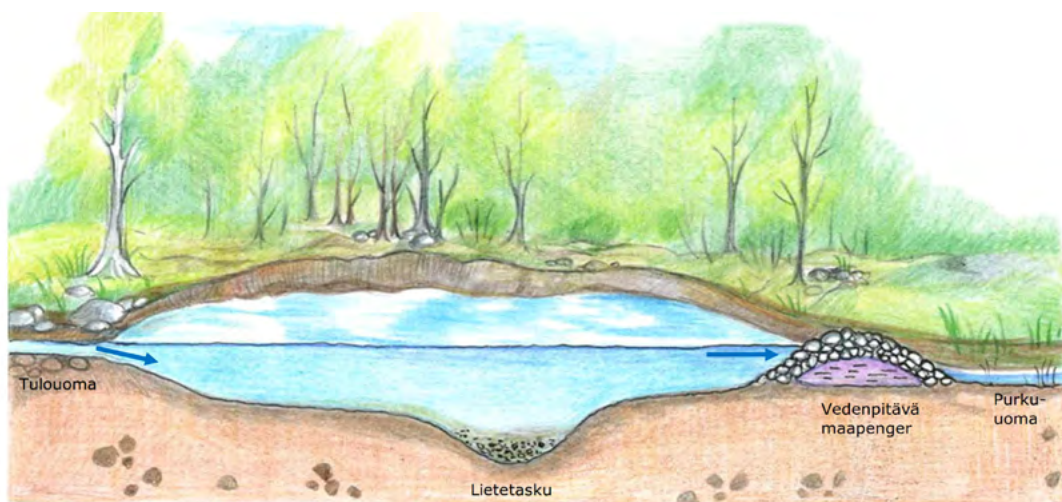
Kuva 19. Laskeutusaltan periaatekuva. Piirros Ramboll / Taru Mäkiranta 2022.
