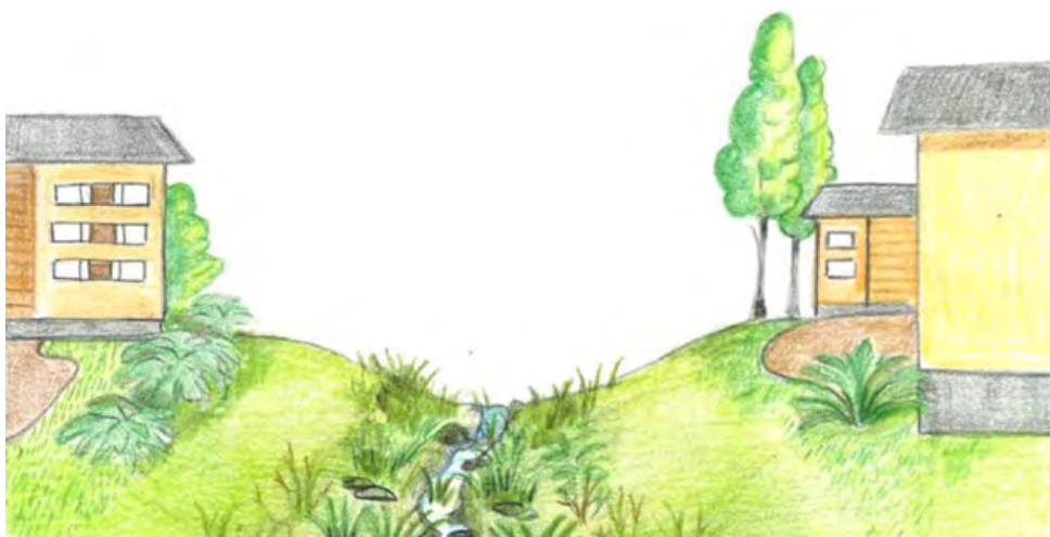
Kuva 23. Avouoma, jossa on varattu tilaa myös tulvavesien johtamiselle. Piirros Ramboll / Taru Mäkiranta 2022.
