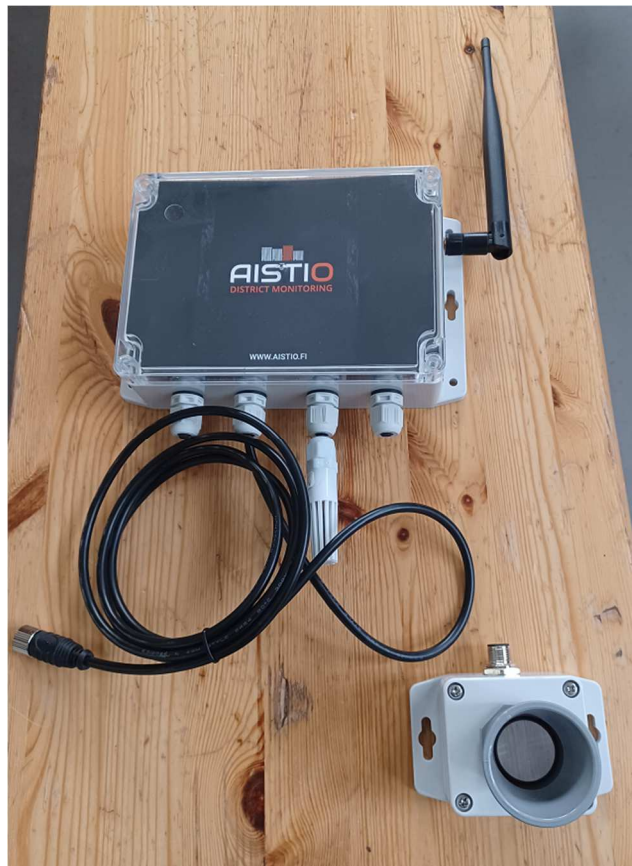
Kuva 4: Aistion pinnanmittauslaitteisto, missä oikealla alhaalla anturi.
