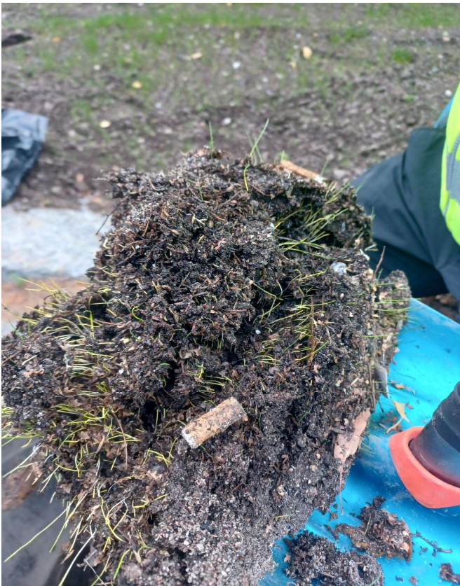
Kuva 2. Hulevesisuodattimeen kerääntynyttä sakkaa kuvattuna tyhjennyksen ja sakanäytteenoton yhteydessä.
