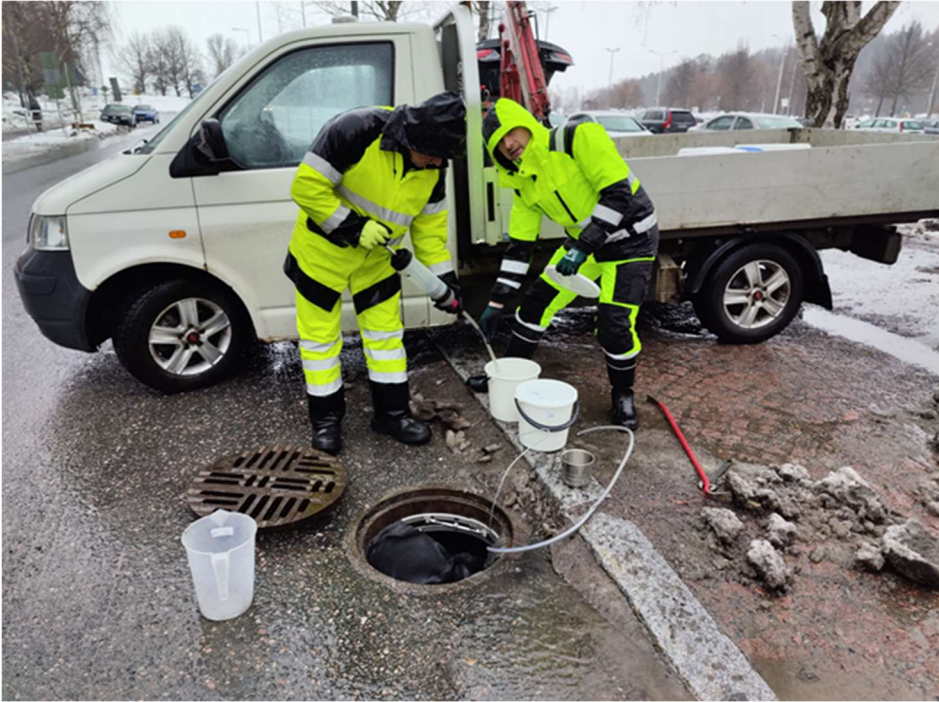
Kuva 1. Sadanta-valuntatapahtuman aikaista hulevesinäytteenottoa Lahdessa keväällä 2022.
