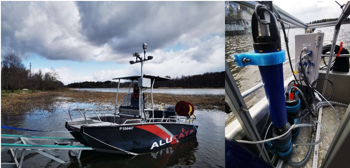
Kuva 2. Espoon Pitkäjärven läpivirtausmittauksia tehtiin toukokuussa 2023 alumiinirunkoisella veneellä, johon oli rakennettu läpivirtausmittauksiin soveltuva laitteisto.
