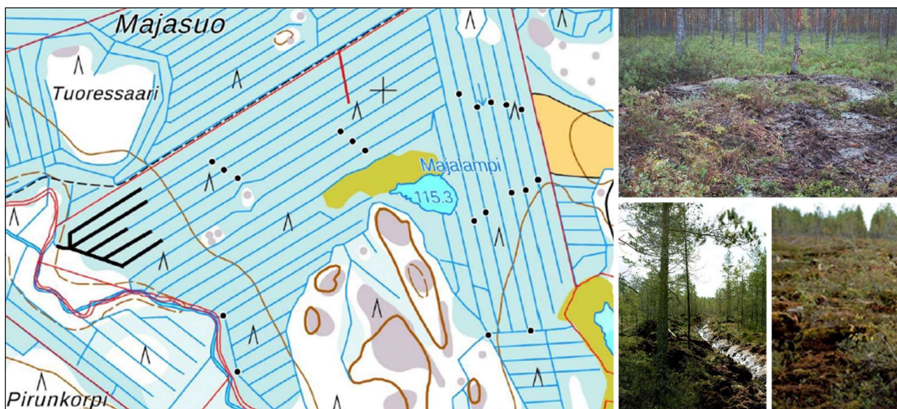
Kuva 7. Majasuo toimenpidekartta ja kuvat turvepadosta, johdeojasta ja tukitusta ojalinjasta. Kartta: Tapio, kuvat: John Nurmisen Säätiö.
