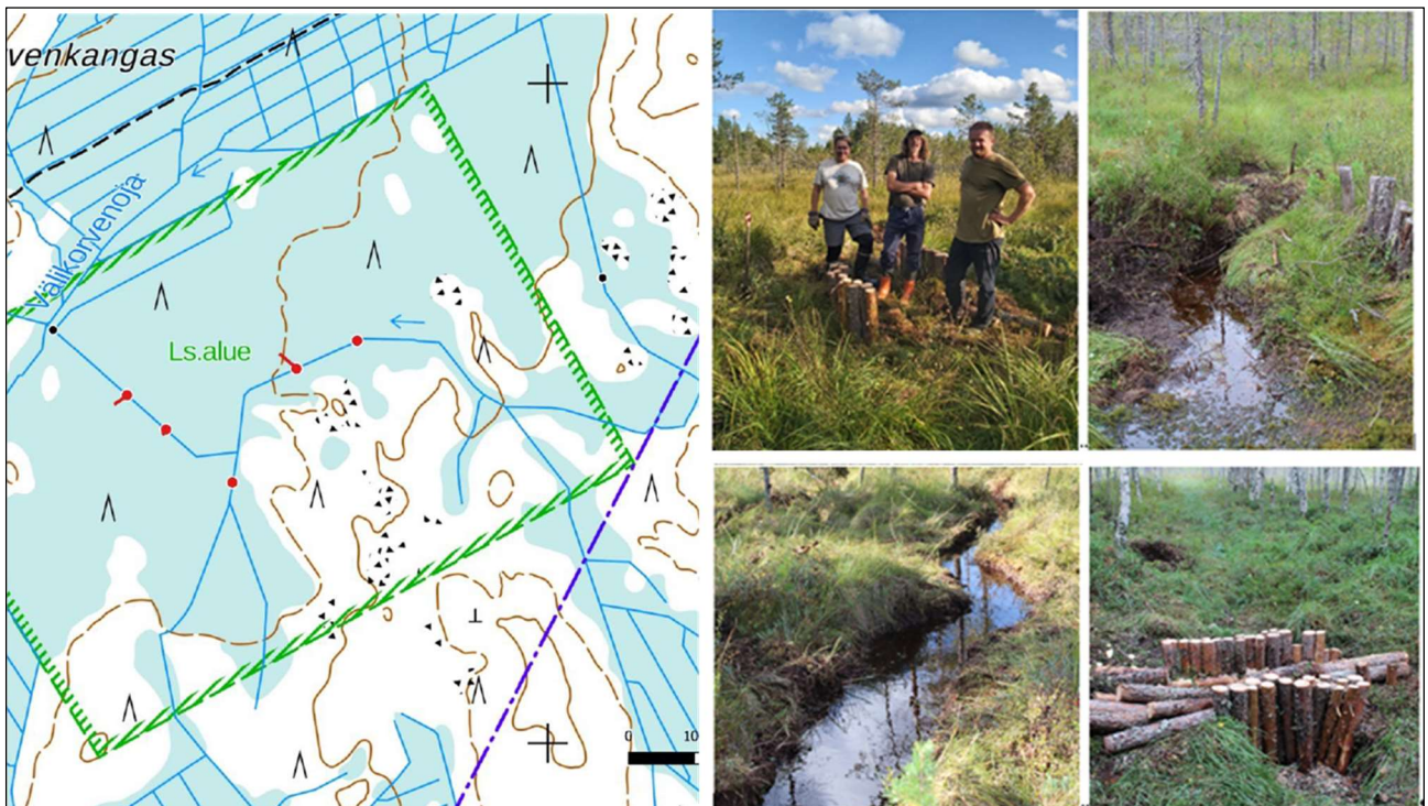
Kuva 6. Kuva 4. Virvatulen toimenpidekartta ja kuvat kahdesta puuvahvisteisesta turvepadosta ja kahdesta johdeojasta. Kartta: Tapio, kuvat: John Nurmisen Säätiö.
