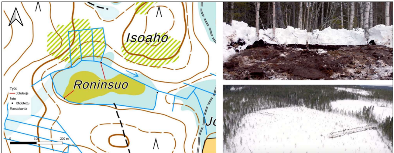
Kuva 4. Roninsuon toimenpidekartta ja kuvat turvepadosta ja avatuista johdeojista. Kartta: Tapio, kuvat: Iin Micropolis
