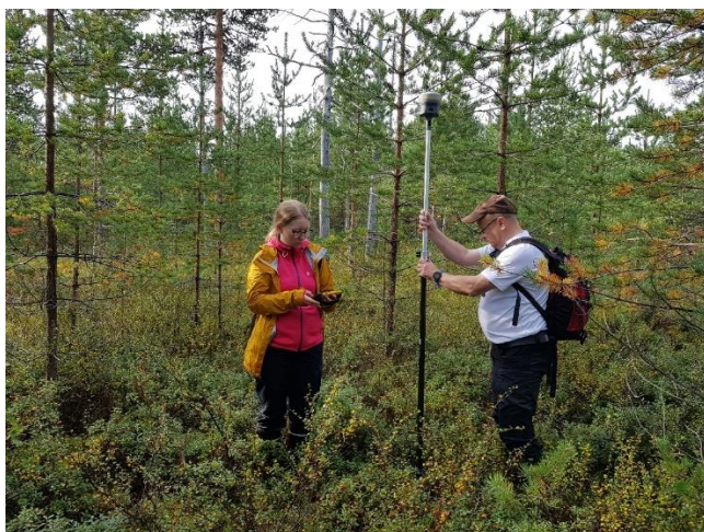
Kuva 4. Tarkkuus-GPS on yhteydessä kämmenlaitteeseen, joka tallentaa reaaliaikaisesti mittaustiedot paikkatiedoksi. Kuva: Jani Antila
