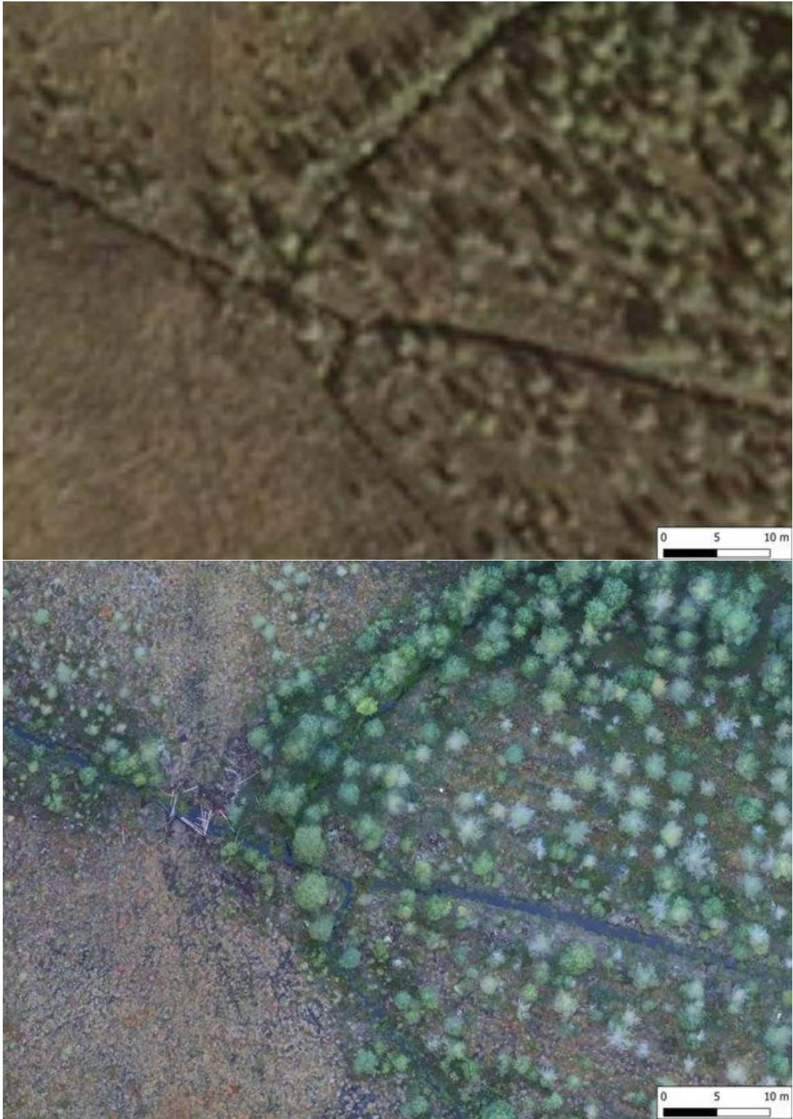
Kuva 24. Kuvaparissa yllä on Maanmittauslaitoksen ortomosaiikkikuva ja alla vastaava dronella kuvattu 2,7 cm:n maastoresoluution kuva Röytänjalan ojitusalueen ja ojittamattoman suon rajalta.
