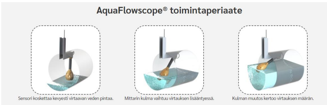
Kuva 4 AquaFlowscopen pintamittauksen periaate
