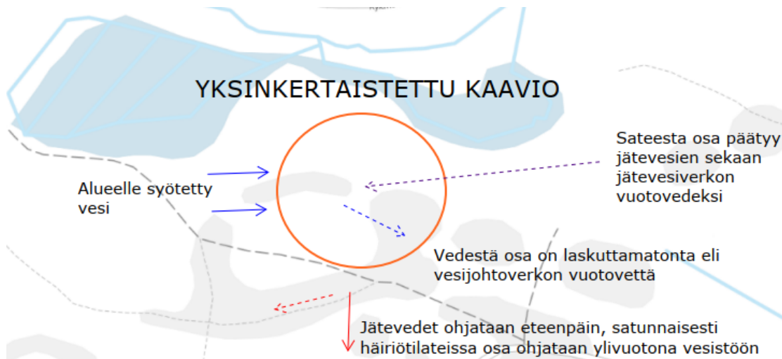
Kuva 2 Yksinkertaistettu kaavio verkoston vesitaseen muodostumisesta
