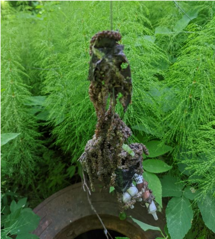
Kuva 28. Keräimiin kertyy herkästi roskaa. Kuva tutkimuspisteestä SW-H6.
