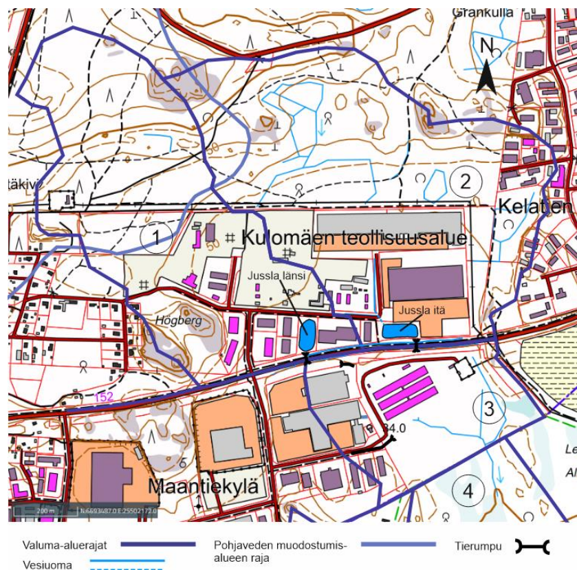
Kuva 1.3. Jusslan hulevesialtaat ja niiden valuma-alueet (1 ja 2) kartalla. Lähteet: Tuusulan karttapalvelu ja Sito Oy (2015).
