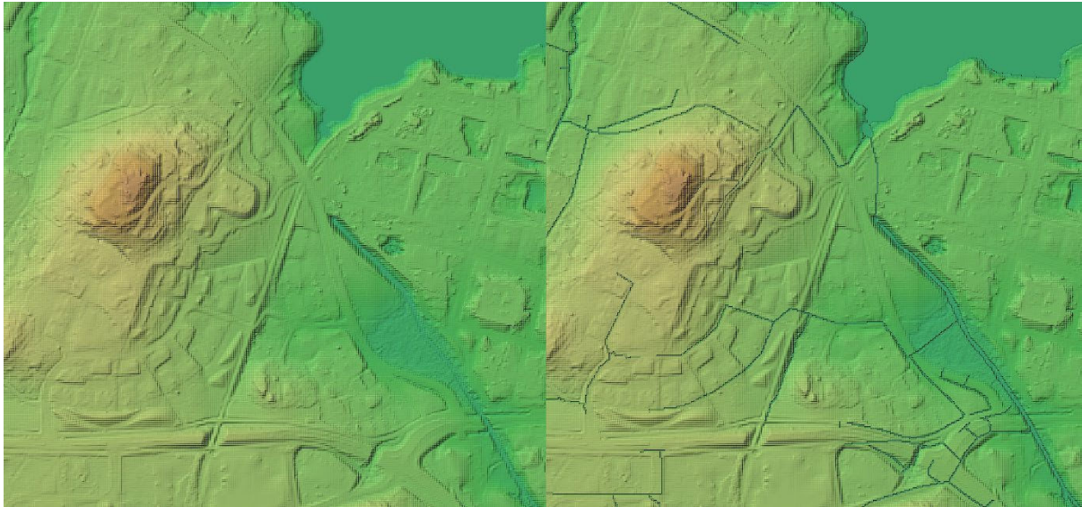
Kuva 35 Vasemmalla polttamaton ja oikealla poltettu korkeusmalli. Polttaminen näkyy korkeusmallissa selkeästi tummempina hiloina ja uomaverkosto on yhtenäisempi.
