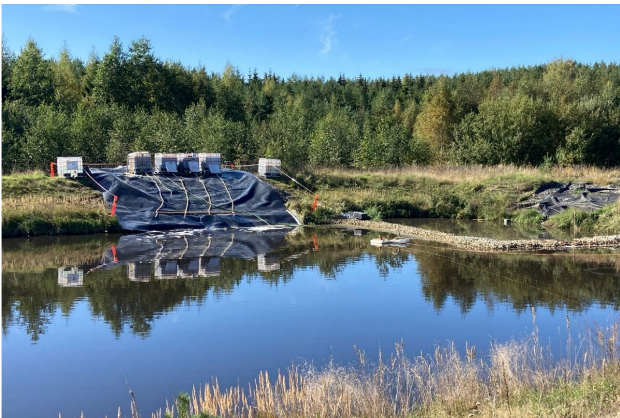
Kuva 2. Koeasetelma rakennettiin suojamuovin päälle, jotta mahdolliset ylivuotovedet valuvat takaisin tasausaltaaseen. Kuva: Anu Koponen 2021
