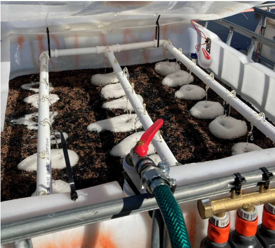
Kuva 3. Suodattimiin asennettu pinnankorkeusanturi lietebiohiili-hiekkasuodattimen oikeassa yläreunassa. Kuva: Anu Koponen 2021
