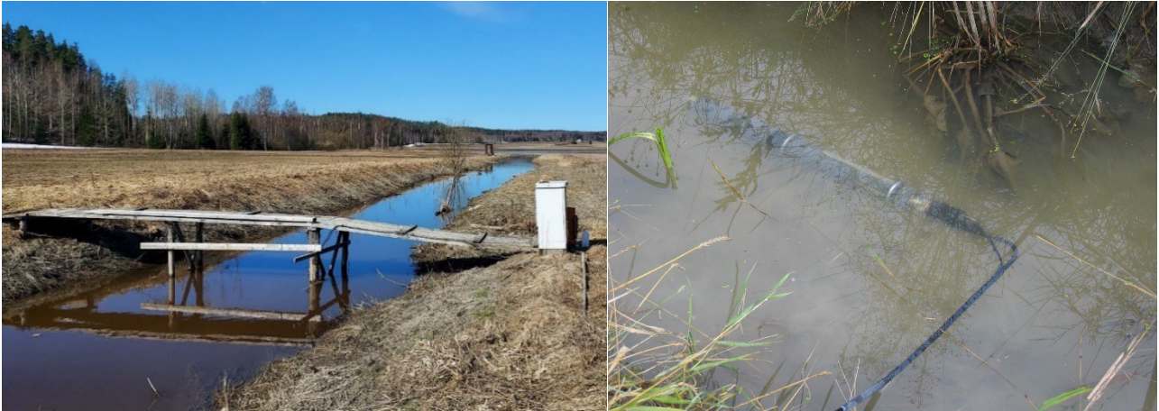
Kuva 3. Kipsin vaikutuksia Lepsämänjoen vedenlaatuun seurattiin valuma-alueen yläosiin asennetun vedenlaatuanturin avulla.
