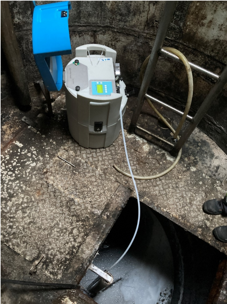
Kuva 1: Kokooma/komposiittinäytekeraän Prusin pumppuaseman huoltotasanteella.
