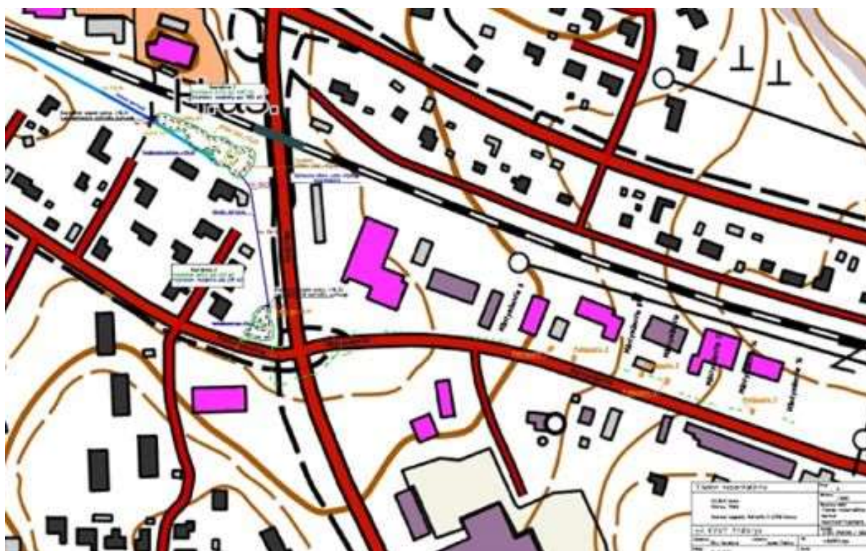
Kuva 9. Taajamatulvista kärsivälle Keuruun Yliahon yritys-, liike- ja asuinalueelle KEURUS-hankkeessa laadittu vesienhallintasuunnitelma. Kuva: Riku Huuskola
