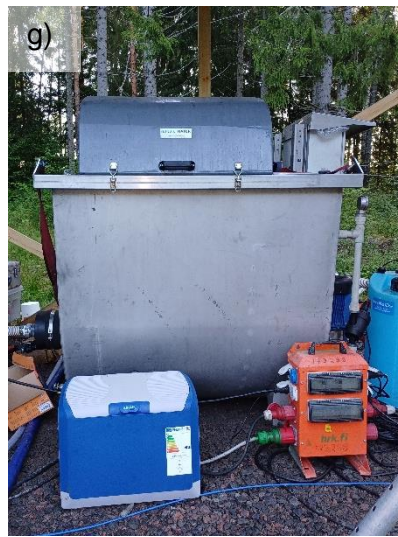
Kuva 6. Linkullasjön-järvellä kesän 2024 aikana toteutetun alusveden suodatuspilotin a) laitteiston yleiskuva, b) syvänteelle asetettu alusveden imuputki, c) järven rantaan asennettu uoppumpu, d) ilmastussammio, e) DynaSand-hiekkasuodatin, f) DynaSandilta lähtevän puhdistetun veden purku järveen laskevaan matalaan, kasvi- ja sammalpeitteiseen ojaan, g) DynaDrum-rumpusuodatin sekä h) rejektivesisammio, josta rejektivedet johdettiin uoppumpulla tiivistetylle siirtolavalle. Kuvat a ja c-h, Laura Härkönen; kuva b, Leena Nurminen.
