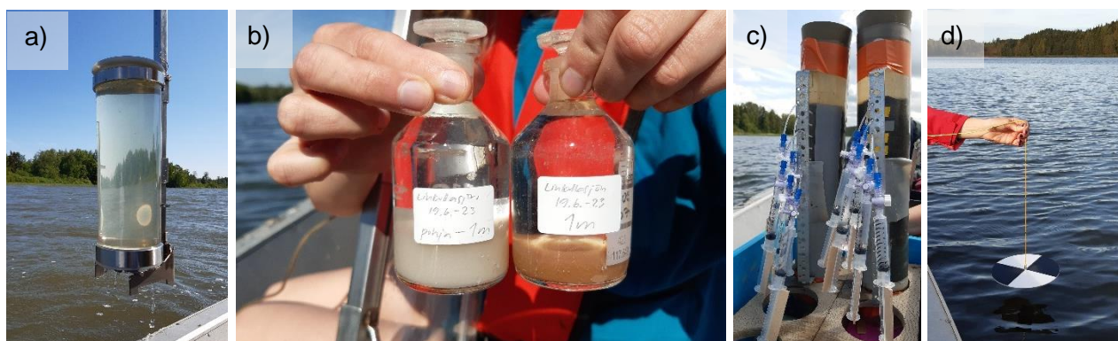
Kuva 4. Valokuvia Linkullasjön-järven näytteenotosta: a) vesinäytteenotossa käytetty Limnos-putkinoudin, b) päänäytteen (oikealla) ja alusveden (vasemmalla) happinäytteet kesäkuussa 2023, c) sedimenttinäytteenotossa käytetyt putkinoutimet ja Rhizon-suodattimet sedimenttien huokosvesinäytteitä varten sekä d) näkösyvyyden mittausta Secchi-levyllä syyskuussa 2024. Kuvat a ja c, Laura Härkönen sekä kuvat b ja d, Kaarina Lukkari.
