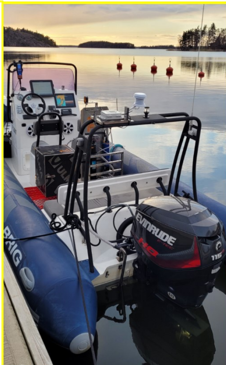
Kuva 2. Brig N610 -veneeseen asennettu läpivirtausjärjestelmä ja kartoituksissa käytetyt anturit.
