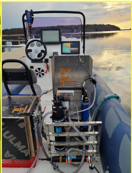
Kuva 2. Brig N610 -veneeseen asennettu läpivirtausjärjestelmä ja kartoituksissa käytetyt anturit.
