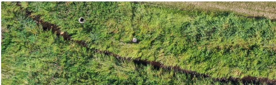
Kuva 1. Dronella kuvattua ilmakuvaa Leppiojan kaksitasouomasta. Keskellä kuvaa näkyy tähyksenä toimiva musta risti vaalealla pohjalla dronekuvien kiinnitystä varten.
