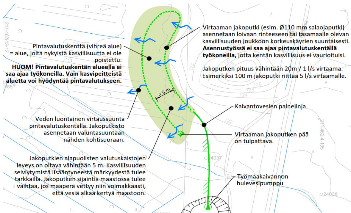
Kuva 5. Periaatekuva pintavalutuskentän toteuttamisesta.
