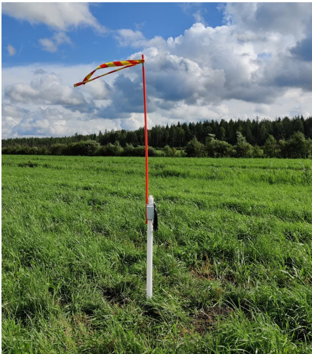
Kuva 3. Yhteistyöviljelijän pellolle asennettu pohjavesiputki. Kun nurmi tai vilja kasvaa, putki jää helposti kasvuston sekaan piiloon ja siksi se on merkittävä kunnolla, jotta korjuuhetkellä se muistetaan kiertää (Kuva: Vilho Tikkanen, Oulun yliopisto).
