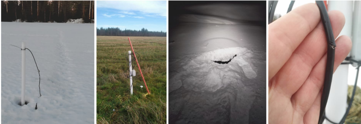
Kuva 9. Mittausten ylläpidolle haasteita tuottivat esimerkiksi eläimet, jotka kävivät välillä kiskomassa antureita pohjavesiputkista tai jyskimässä johtoja (Kuvat: Miika Läpikivi ja Vilho Tikkanen, Oulun yliopisto).
